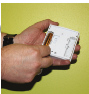
2. Vložte dvě AA baterie (součást balení). Pokud montujete termostat poprvé, prosím odložte jej a otočte na stranu 6.
